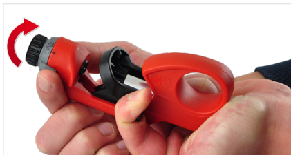
Abisoliergerät entsperren durch Drehen vom Stelling auf das Symbol Rund-schnitt (●)
