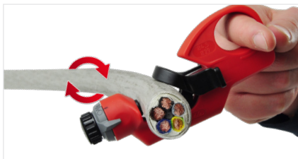
Gerät auf die Markierung der Abisolierlänge aufsetzen und den Rundschnitt durchführen
