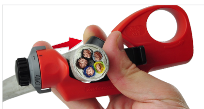
Für Längsschnitt Stellung auf das Symbol Längsschnitt (→) umstellen und Gerät axial in Längsrichtung ziehen
