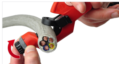
Stellung auf das Symbol Spiralschnitt (〰) umstellen und Arbeitsgang durchführen
